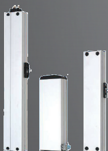
Ketjuavaajat 1Mxx- 24 VDC, 1 - 2 A, IP 20 - 22, 150 - 400N 230 VAC, 0,5 - 0,7 A, IP 20 - 22, 150 - 400 N 200-835 mm
